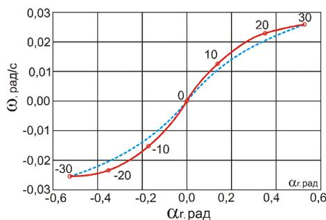
Рис. 1. Экспериментальная кривая и кубическая парабола, определяемая коэффициентами  $K, v_1, v_2$
