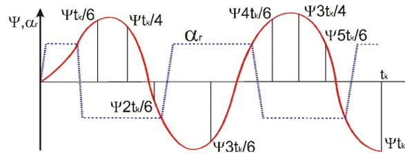
Рис. 4. Схема изменения курса  $\psi$  и угла перекадки руля  $\alpha_r$  при выполнении манёвра "Зигзаг"
