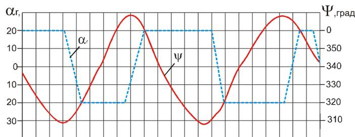
Рис. 2. Изменение угла перекадки руля  $\alpha_r$  и курса судна  $\psi$  при выполнении манёвра "Зигзаг" (натурный эксперимент)
