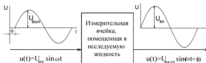
Рис. 1. К определению коэффициента передачи измерительной ячейки
