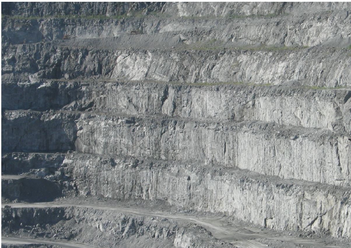
Рис. 8. Формирование борта карьера с использованием вертикальных уступов высотой 24 м (основной карьер ОАО "Ковдорский ГОК")
