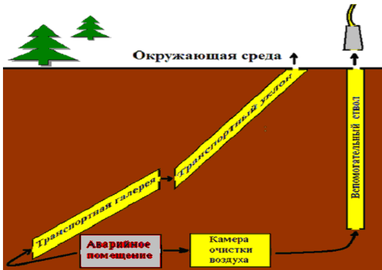
Рис. 1. Принципиальная схема аварии на подземном хранилище неперерабатываемого ОЯТ
