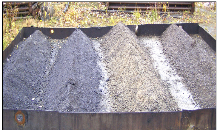
Рис. 5. Утилизация мазута, смешанного с песком и нефтеокисляющей микрофлорой на сорбенте-носителе, в буртах на поддоне
