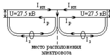
Рис. 3. Четырехконтурная схема замещения влияющего участка железной дороги
