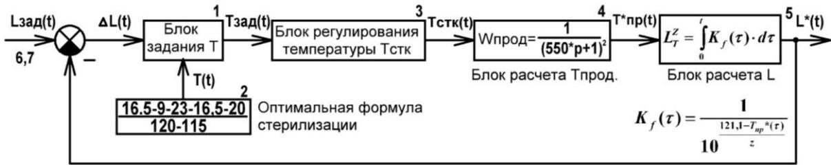
Рис. 1. Структурная схема контура регулирования фактического стерилизующего эффекта в АВК-30М при модернизированном способе стерилизации
