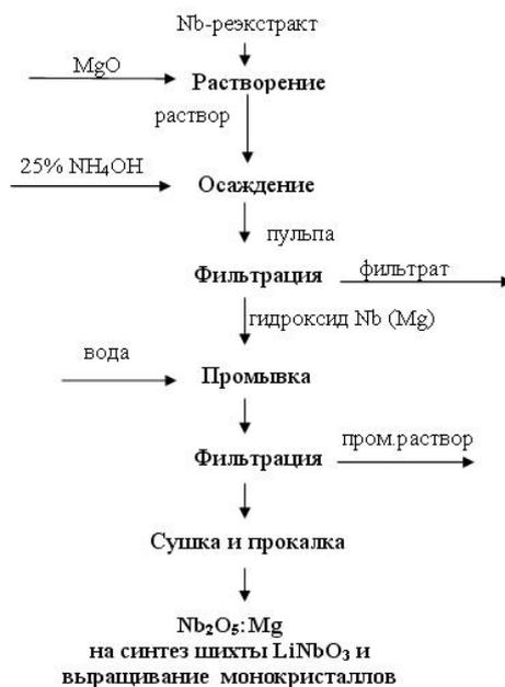
Рис. 1. Схема получения образцов пентаоксидов ниобия, допированных катионами  $Mg^{2+}$
