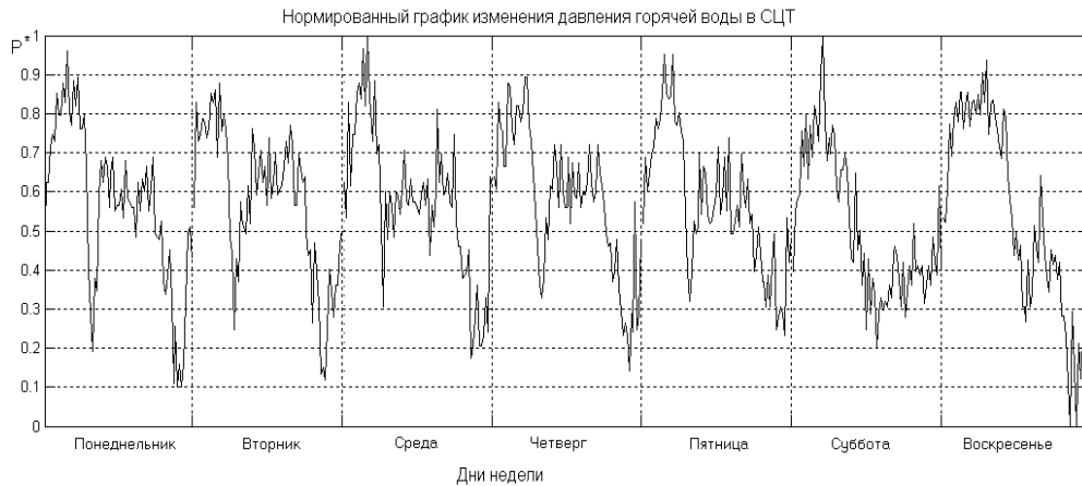
Рис. 6. Нормированный график потребления горячей воды в микрорайоне ЦТП № 1 за период 15.01 – 29.01.2012 г.
