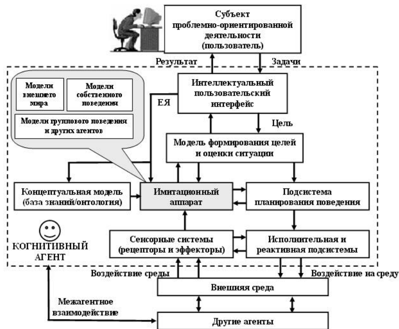
Рис. 4. Гибридная архитектура когнитивного агента с имитационным аппаратом
