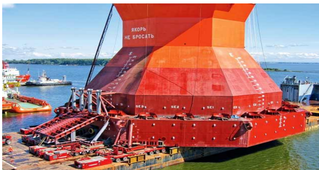
Рис. 3. Выгрузка установки весом 10 000 тонн с помощью СМТ в Калининградском порту; http://www.os1.ru/article/truck/2012_12_A_2012_12_10-15_13_09/
