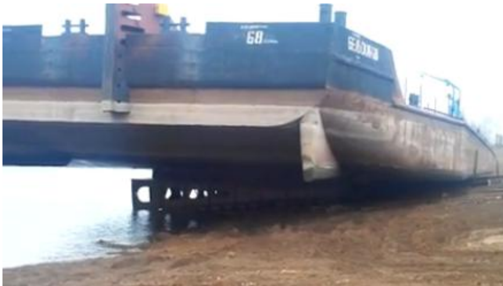
Рис. 4. Подъем (вытаскивание) баржи с грузом по слипу;
