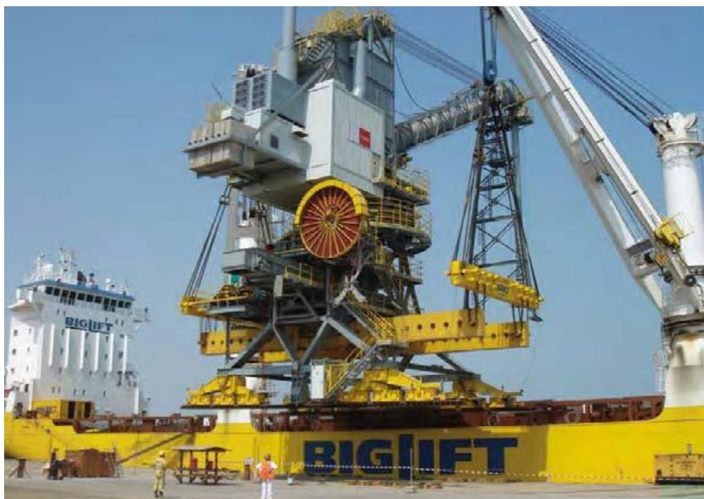
Рис. 6. Выгрузка КТГ на причал, осуществляемая с помощью судовых кранов компании Biglift ; http://www.bigliftshipping.com/assets/data/bignews/BigNews
