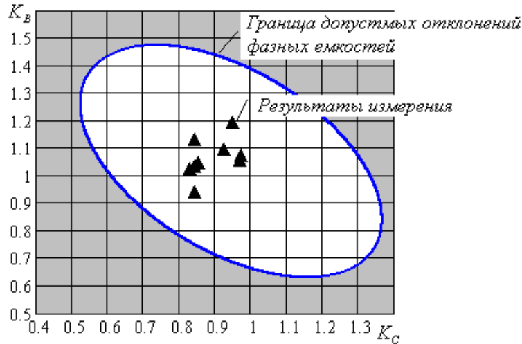
Рис. 4. Отклонения отношений фазных емкостей K_B и K_C от резонансных значений
