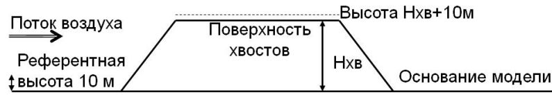
Рис. 1. Схема модели под обоснование методики определения интенсивности пыления
