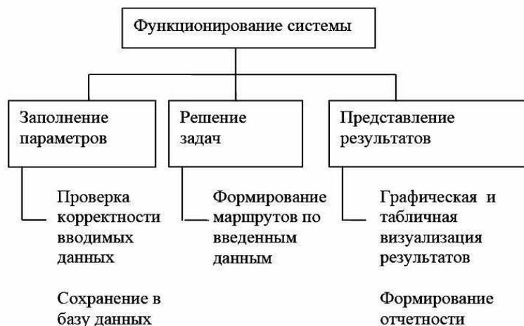
Рис. 3. Функциональная схема АИС УЛО
