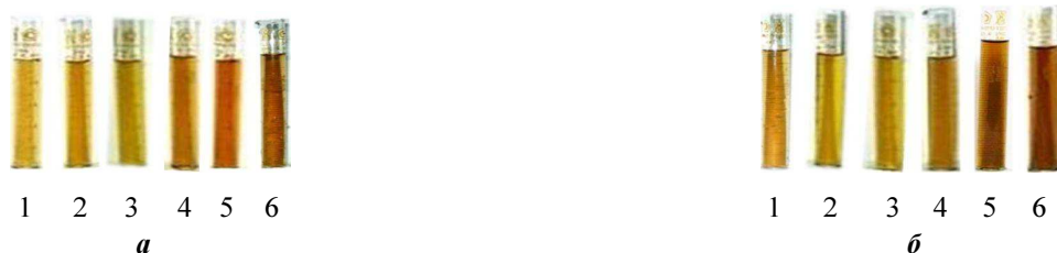
Рис. 3. Внешний вид образцов копильной жидкости AS: a – площадь ТОП 1,34 \text{ м}^2 ; b – площадь ТОП 2,00 \text{ м}^2 Fig. 3. Appearance of samples of AS liquid smoke: a – the HTS area – 1.34 \text{ м}^2 ; b – the HTS area – 2.00 \text{ м}^2
