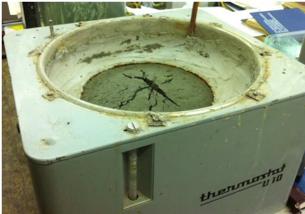
Рис. 3. Выпуклость забоя лабораторной установки Fig. 3. Convexity of the bottomhole of the laboratory setup
