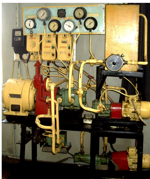
Рис. 3. Лабораторный стенд для испытания роторных насосов Fig. 3. The laboratory test bench for testing rotary pumps
