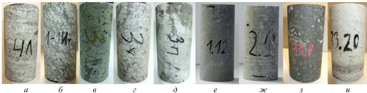
Рис. 2. Образцы исследуемых скальных горных пород: a – линзовидно-полосчатой апатит-нефелиновой руды; b – ийолита трахитоидного; в – уррита среднезернистого массивного; г – уррита неравномерно-зернистого; д – уррита пегматоидного; e – гнейса серого лейкократового; ж – гнейса серого апатит-карбонатно-магнетитовой руды; з – апатит-карбонатно-магнетитовой руды; и – кальцитового карбонатита Fig. 2. The samples of the studied hard rocks: a – lenticular striped apatite-nepheline ore; b – trachytoid ijolite; в – medium-grained massive urtite; г – inequigranular urtite; д – pegmatoid urtite; e – gray gneiss; ж – leucocratic gray gneiss; з – apatite-carbonate-magnetite ore; и – calcite carbonatite
