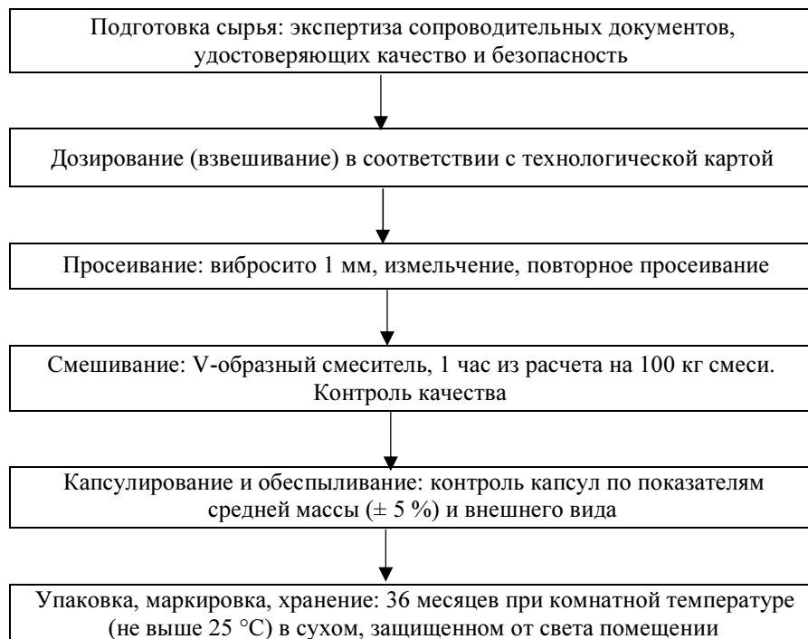
Рис. Технологическая схема производства капсулированной формы БАД Fig. Technological scheme of the production of encapsulated dietary supplements
