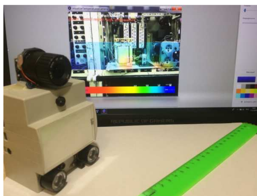
Рис. 8. Детектор извещателя для непрерывного ИК- и видеоконтроля технического состояния электрооборудования
