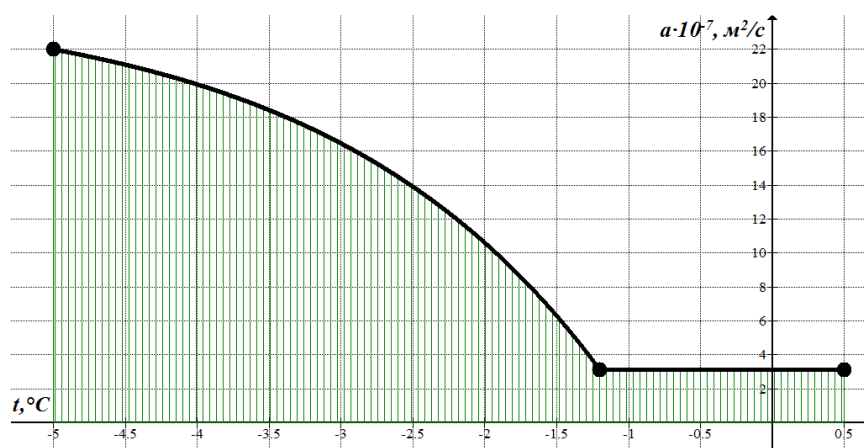
Рис. 5. Зависимость коэффициента температуропроводности фарша от его средней температуры Fig. 5. The dependence of the thermal diffusivity of minced meat on its average temperature
