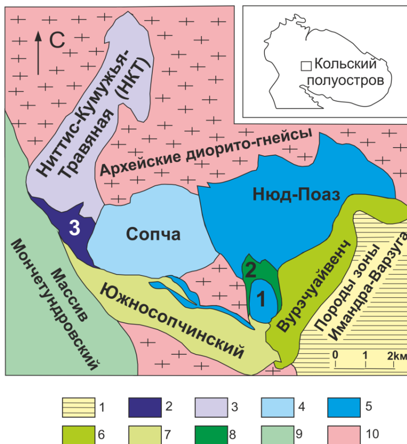
Рис. 1. Схема геологического строения Мончегорского рудного района: 1 – metabasalts, epidote-amphibole and amphibole-biotite schists, tuff-siltstones with quartzite interbeds; 2 – dunites; 3 – orthopyroxenites and harzburgites; 4 – pyroxenites; 5 – norites; 6 – gabbronorites, leucocratic gabbro and anorthosites; 7 – leucocratic and mesocratic gabbronorites; 8 – quartz gabbro; 9 – leucocratic gabbro, gabbronorites and anorthosites; 10 – diorite-gneisses, metadiorites, and garnet-biotite gneisses. Цифрами обозначены: 1 – массив Морошковое озеро; 2 – массив Габбро-10; 3 – Дунитовый блок
