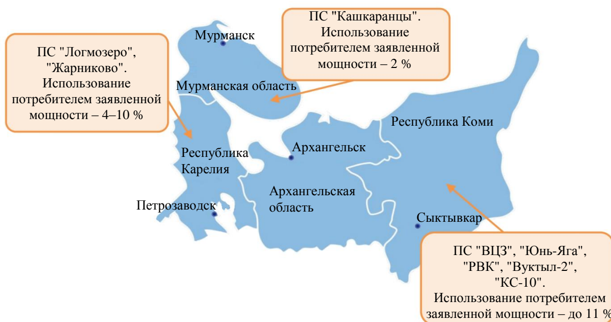
Рис. 7. Использование потребителями заявленной мощности (по данным ПАО "Россети Северо-Запад") Fig. 7. Use of declared capacity by consumers (according to PJSC "Rosseti North-West")
