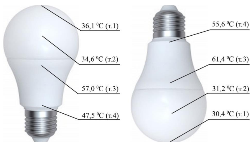
Рис. 10. Распределение температуры по корпусу лампы Uniell LED-A60-9W/4000K Fig. 10. Temperature distribution over the lamp body Uniell LED-A60-9W/4000K
