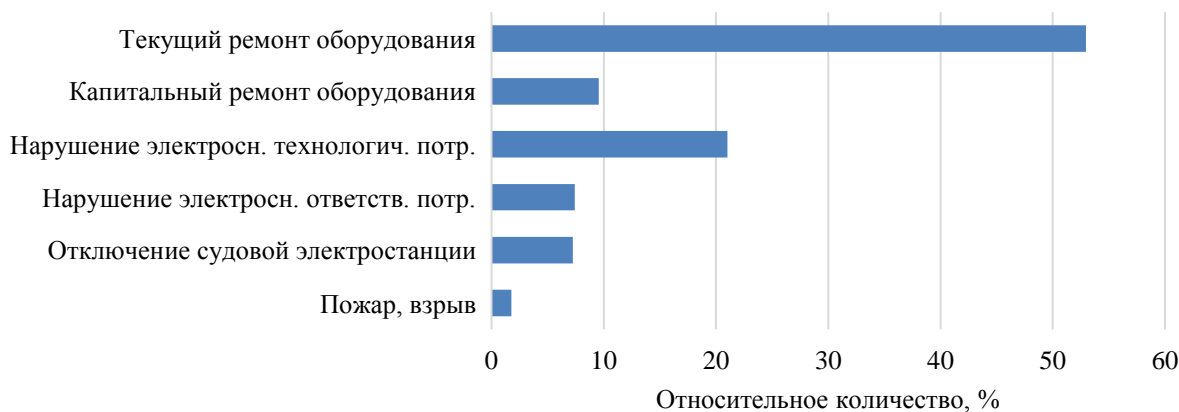
Рис. 11. Распределение однофазных замыканий по их последствиям Fig. 11. Distribution of single-phase faults by their consequences
