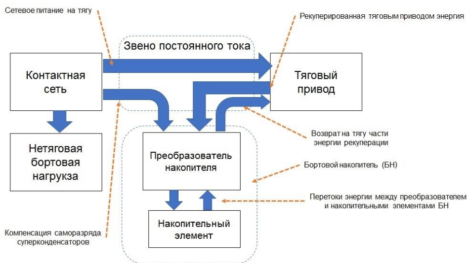
Рис. 1. Схема тяговой цепи ПС с бортовым накопителем. Стрелками показаны направления энергопотоков Fig. 1. Diagram of the traction chain of a rolling stock with an on-board drive. The arrows show the directions of energy flows
