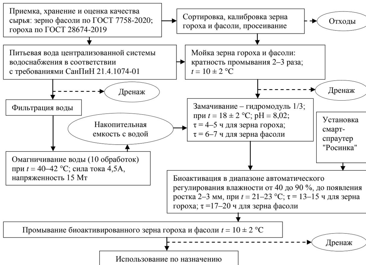
Рис. 1. Технологическая схема производства биоактивированного зерна гороха и фасоли исследуемых сортов
