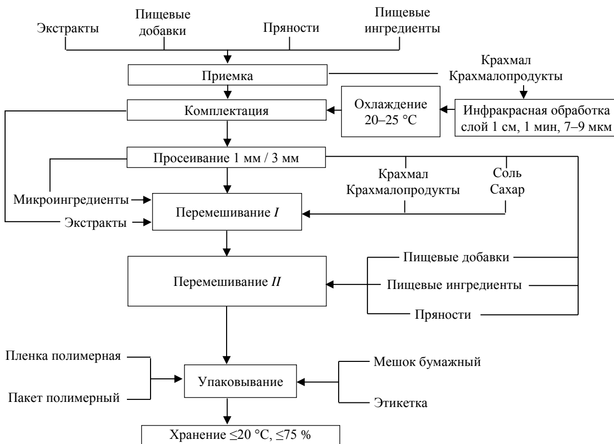
Рис. 6. Технологическая диаграмма производства добавок пищевых комплексных с этапом обработки носителя инфракрасным излучением
