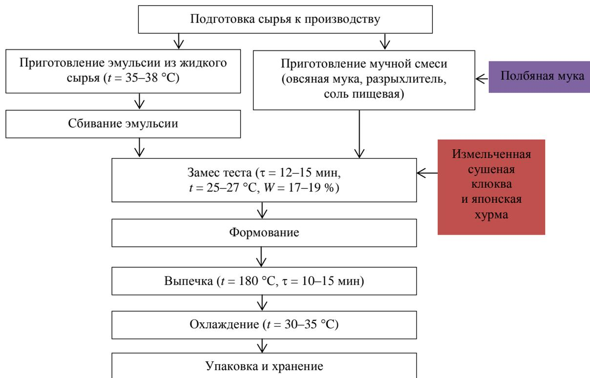
Рис. 1. Технологическая схема производства овсяного печенья по разработанной технологии
