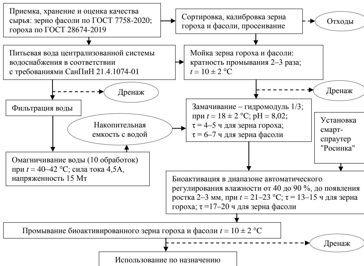
Рис. 1. Технологическая схема производства биоактивированного зерна гороха и фасоли исследуемых сортов Fig. 1. Technological scheme for the production of bioactivated grain peas and beans of the studied varieties
