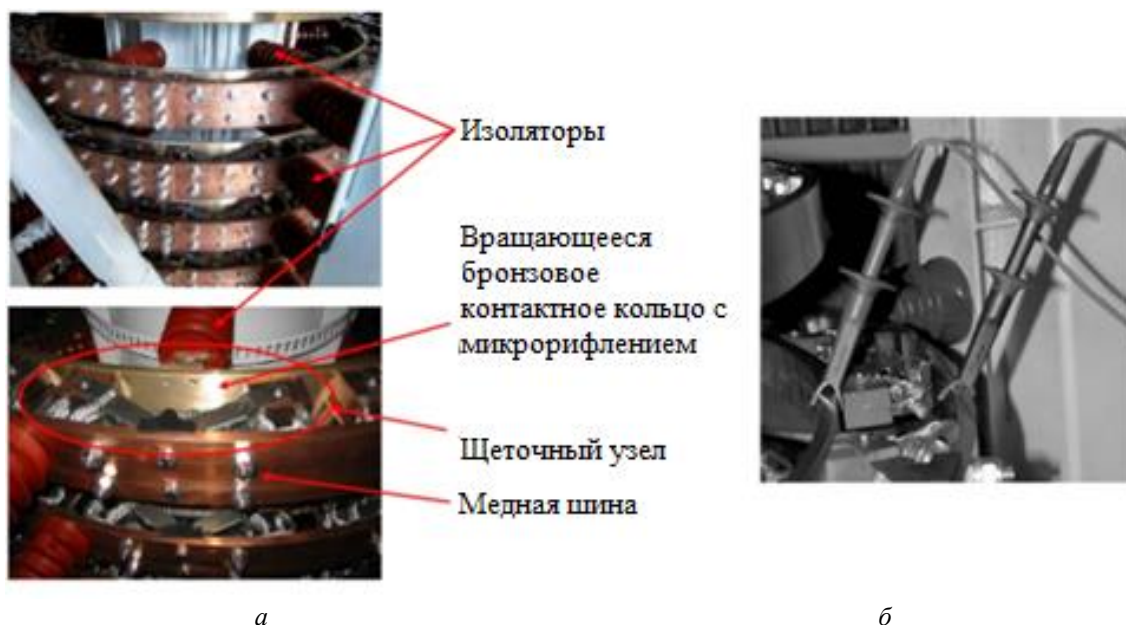
Рис. 2. Элементы узла контактных колец (а) и методика измерения сопротивления между контактными кольцами и наружной шиной (б) Fig. 2. Elements of the slip ring assembly (a) and the method of measuring the resistance between the slip rings and the outer bus bar (b)
