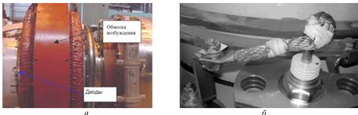
Рис. 7. Устройство возбуждения (а) и диод бесщеточного выпрямителя (б) Fig. 7. The excitation device (a) and the brushless rectifier diode (b)
