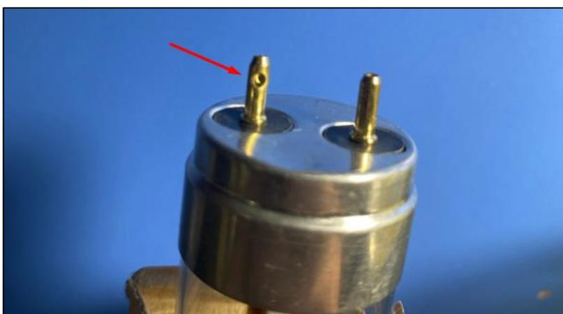
Рис. 5. Механический зажим гибкого проводника с штырьком цоколя
