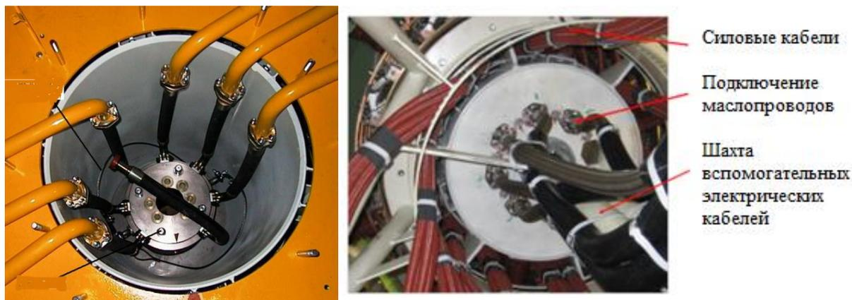
Рис. 4. Узлы соединения маслопроводов с ВРК (а – внешняя часть; б – внутренняя часть)
