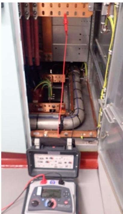
Рис. 6. Измерение сопротивления изоляции обмотки статора ГЭД высоковольтным мегаомметром
