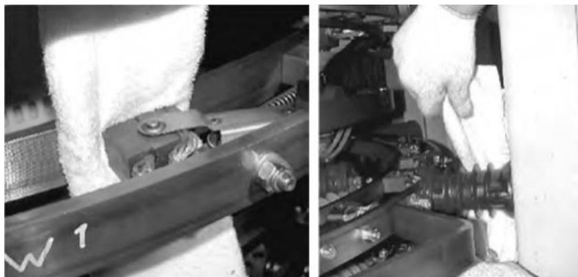
Рис. 3. Чистка щеток и изоляторов
