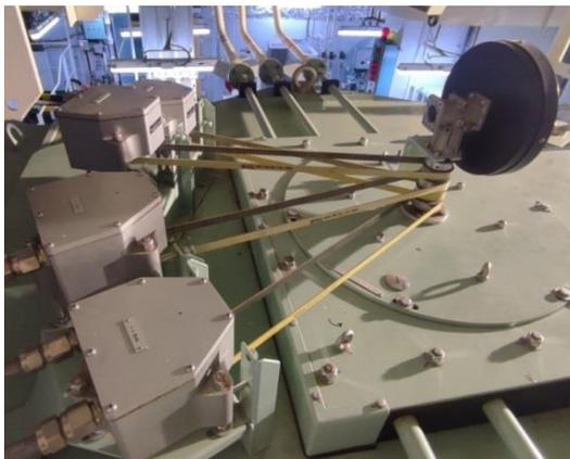
Рис. 13. Модуль обратной связи положения гондолы
