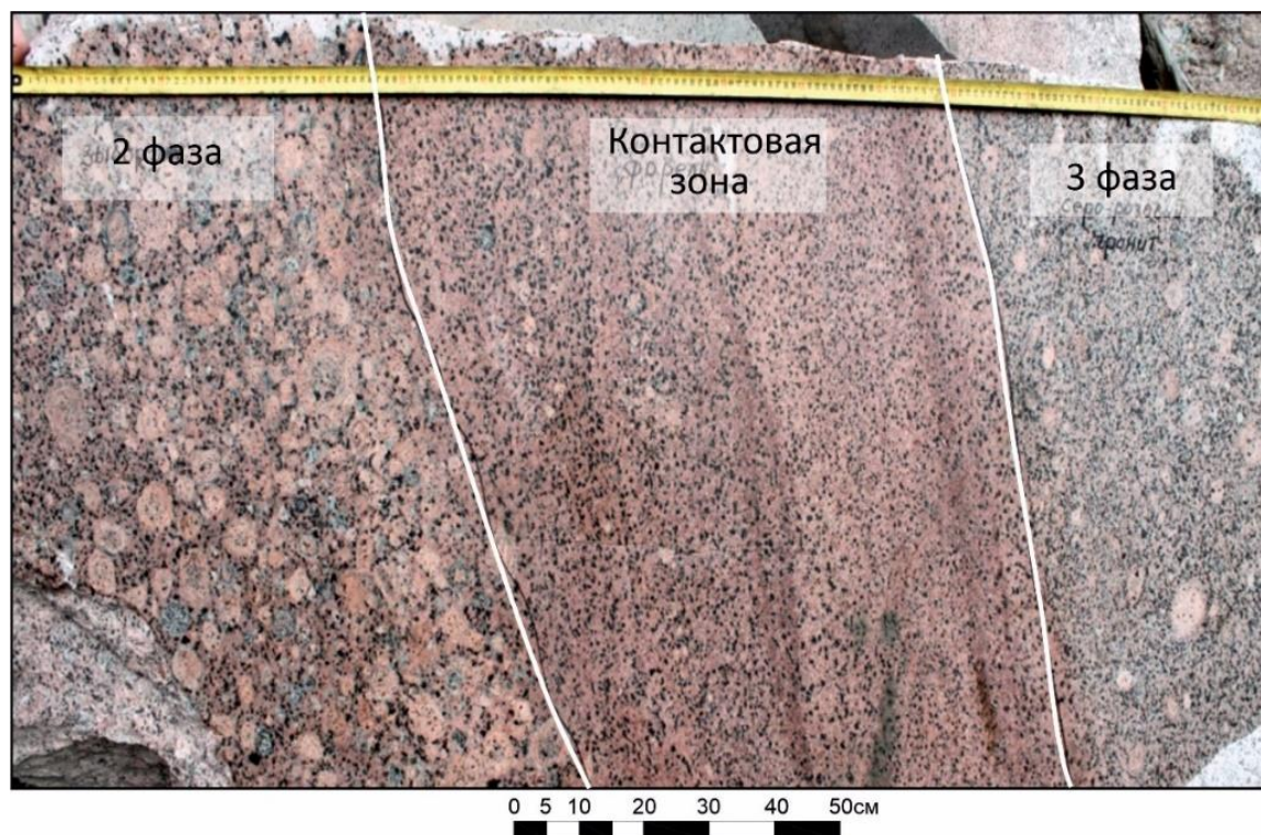
Рис. 2. Фотография контактовой зоны между гранитами второй (овоидные граниты) и третьей (трахитоидные граниты) фаз в блоке породы. Фотография взята из производственного отчета (с разрешения горного управления ПО "Возрождение")
