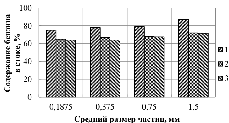
Рис. 4. Содержание бензиновых фрагментов в стоках через слои песка толщиной 2,5–3 см (1), 5 см (2), 8 см (3) Fig. 4. The content of gasoline fragments in drains through layers of sand with a thickness of: 1 – 2.5–3 sm; 2 – 5 sm; 3 – 8 sm
