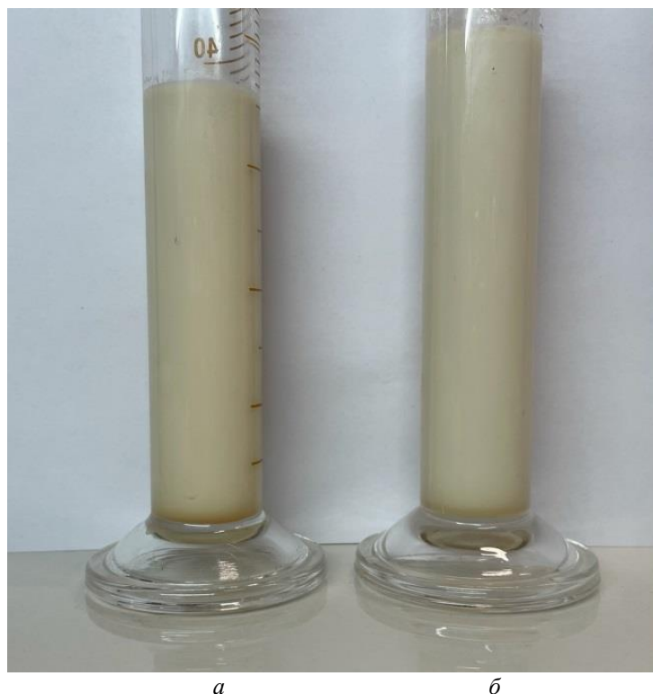
Рис. 3. Эмульсии гидролизатов с растительным маслом: a – из свежемороженой кожи, б – из соленой кожи Fig. 3. Emulsions of hydrolysates with vegetable oil: a – from freshly frozen skin, б – from salted skin
