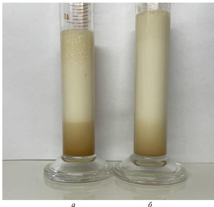
Рис. 4. Эмульсии после отстаивания в течение 7 дней: а – свежемороженой кожа, б – соленая кожа Fig. 4. Emulsions after settling for 7 days: a – freshly frozen skin, b – salted skin
