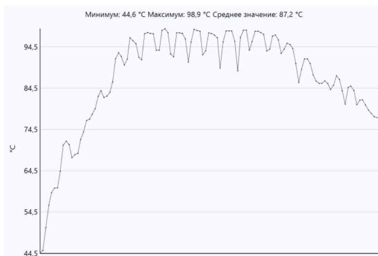
Рис. 4. Тепловые профили для солевого раствора 5%-й концентрации, выпариваемого при режиме 1: a – заполненный; б – линейный (составлены авторами)
