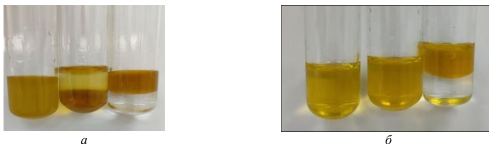
Рис. 5. Тест на растворимость: а – фракции 1; б – фракции 2. Растворители слева направо: гексан, спирт, вода Fig. 5. Solubility test of fractions: а – fraction 1; б – fraction 2; solvents from left to right: hexane, alcohol, water
