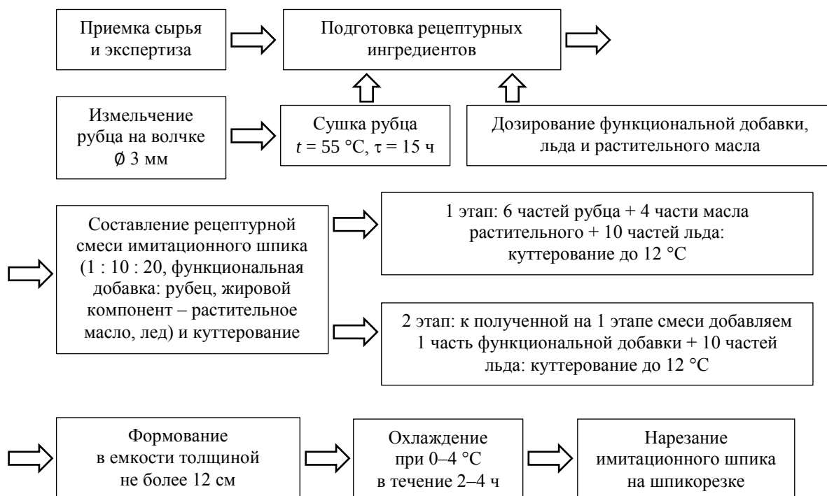
Рис. 4. Технологическая схема производства имитационного шпика из говяжьего рубца Fig. 4. Technological scheme for the production of imitation bacon from beef tripe
